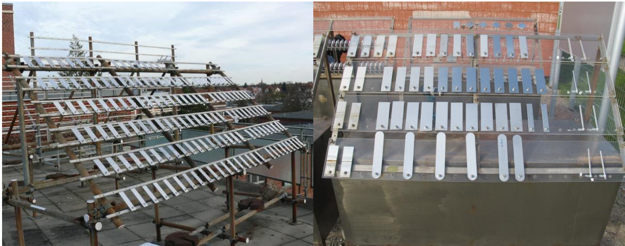
Abb. 12: Übersicht Auslagerungsstände Stadtatmosphäre (l.) und maritime Atmosphäre (r.)
